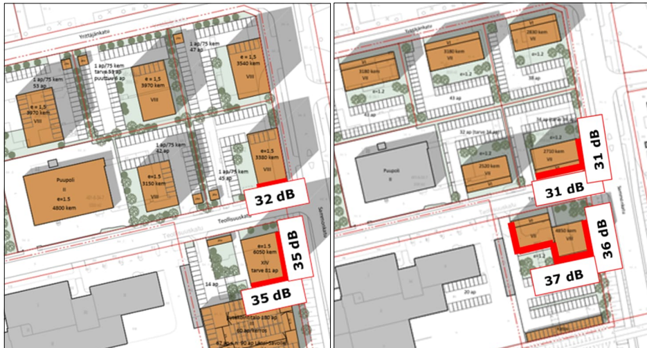
Kuva 11 Julkisivuille kohdistuvat ääneneristävyysvaatimukset enimmäisäänitasojen LAF_{max} perusteella.
