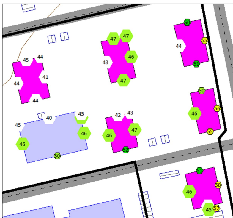
Kuva 6 Julkisivuille kohdistuvat korkeimmat keskiäänitasot ennustetilanteessa 2040 yöllä. Pistetaloversio.
